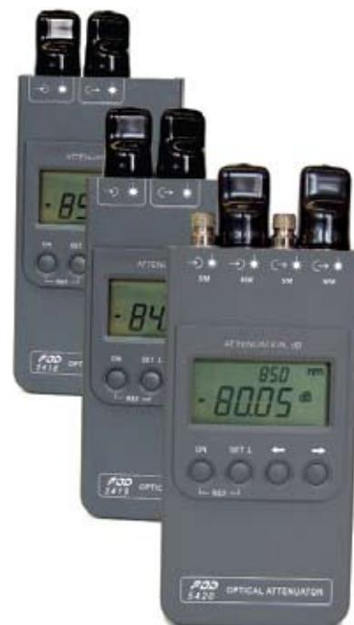
**Программируемые оптические аттенюаторы FOD 5418, FOD 5419, FOD 5420** предназначены для внесения задаваемого оператором затухания в одномодовый или многомодовый волоконно-оптический тракты на длинах волн 1310 и 1550нм или 850 и 1310 нм. Аттенюаторы позволяют установить значения затуханий от 0 до 80 дБ с разрешением 0.05 дБ. Имеется возможность оперативного изменения значения вносимого затухания.
