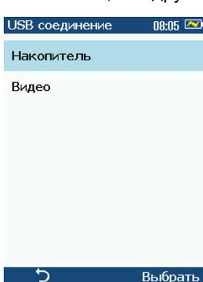
Для подключения видеоскопа к внешнему компьютеру через интерфейс USB 1.1 с помощью соединительного кабеля USB микро B – USB A соедините разъемы USB видеоскопа и компьютера. На экране видеоскопа откроется страница **USB соединение**.
