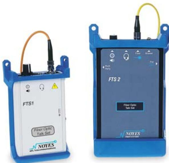
Волоконно-оптические переговорные устройства (FTS) - это экономичное техническое решение задачи обеспечения голосовой связи при тестировании многомодовых и одномодовых оптических кабелей.
